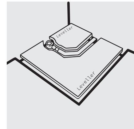
Die Bodenaussparung mit dem Leveller ausgleichen.
