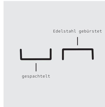
Die Abdeckung der Ablaufrinne kann zweiseitig genutzt werden. Für die gespachtelte Optik die Edelstahlschiene mit EP grundieren und absanden. Anschließend die Vertiefung mit EP Estrich auffüllen. Nach vollständiger Trocknung kann die HardRock-Oberfläche aufgebracht wrden. Die zweite Seite der Abdeckung ist in Edelstahl gebürstet gestaltet.
