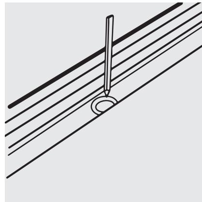
Element:one **trocken** setzen und die Position des Ablauftopfes anzeichnen. Alternativ das Achsmaß ausmessen.
