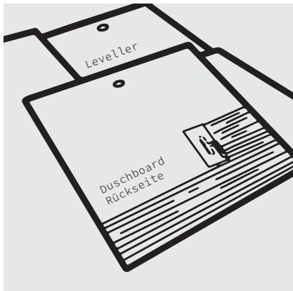
Mit einem Zahnpachtel 8 mm **C2 Flexkleber** vollflächig auf der Unterseite des Element:one aufbringen.
