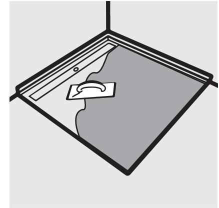
Nach vollständiger Trocknung der Abdichtungslage kann die Oberfläche des Duschboards mit dem gewünschten HardRock-System überarbeitet werden.
