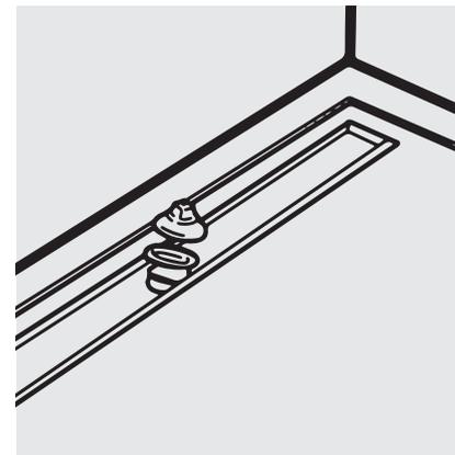
Um das Element:one und den Ablauftopf zu verbinden, das Schraubstück einsetzen und mit der beiliegenden Schraubhilfe festdrehen.
