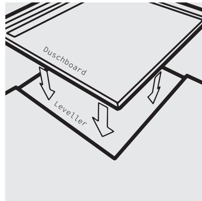
Element:one verlegen und ausrichten.
