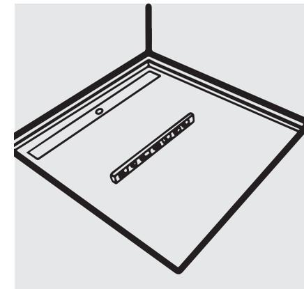
Der korrekte Sitz des Element:one kann mittels Wasserwaage geprüft und gegebenenfalls angepasst werden.
