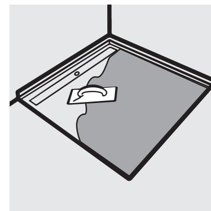
Nach vollständiger Trocknung der Abdichtungslage kann die Oberfläche des Duschboards mit dem gewünschten HardRock-System überarbeitet werden.
