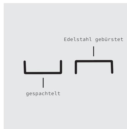
Die Abdeckung der Ablaufrinne kann zweiseitig genutzt werden. Für die gespachtelte Optik die Edelstahlschiene mit EP grundieren und absanden. Anschließend die Vertiefung mit EP Estrich auffüllen. Nach vollständiger Trocknung kann die HardRock-Oberfläche aufgebracht werden. Die zweite Seite der Abdeckung ist in Edelstahl gebürstet gestaltet.
