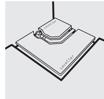
Die Bodenaussparung mit dem Leveller ausgleichen.
