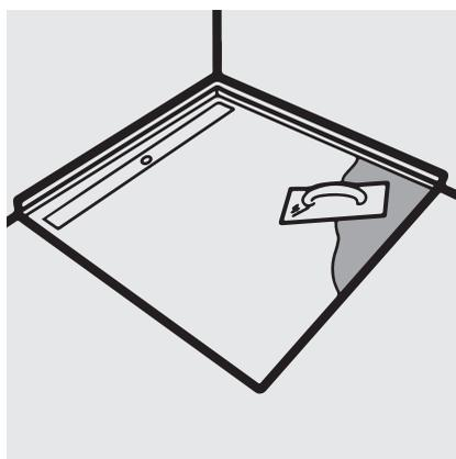
Die Übergänge von Wand oder Estrich zum Element:one mit Dichtbändern versehen (Abdichten nach gültigen DIN 18354). Anschließend die Oberfläche des Duschboards mit einer **dünnen Kratzspachtelung** der Abdichtung überarbeiten.
