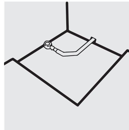
Den Ablauftopf an die vorhandene Entwässerung anschließen und entsprechend ausrichten. Verbindungen auf **Dichtigkeit prüfen**.
