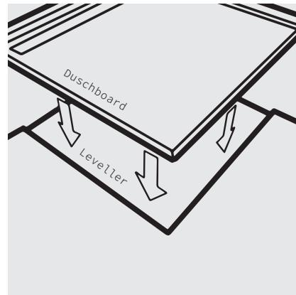
Element:one verlegen und ausrichten.
