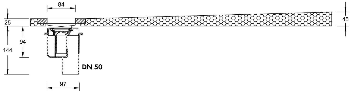
Aufbauhöhe Oberkante Element bis Unterkante Ablauf
