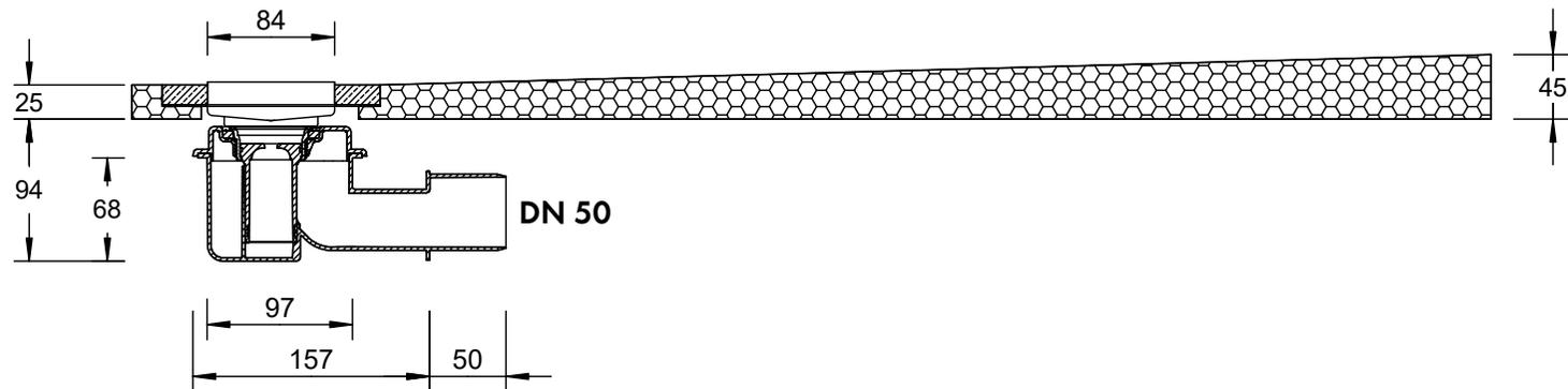
Aufbauhöhe Oberkante Element bis Unterkante Ablauf
